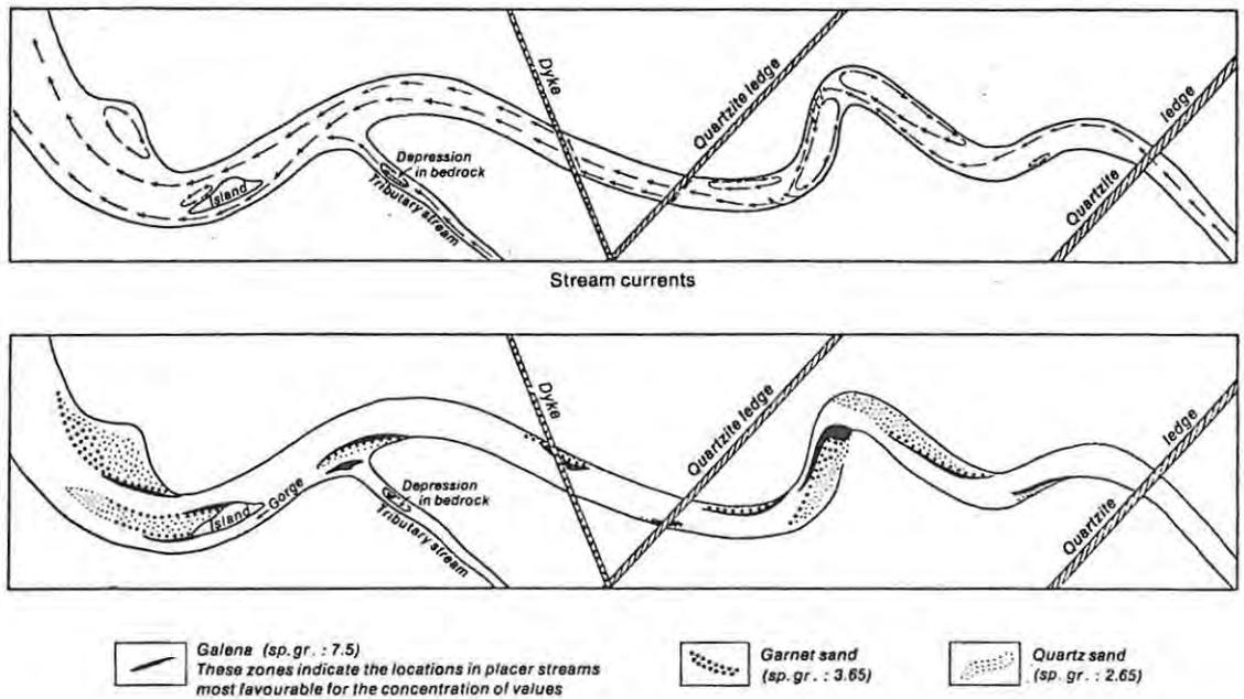
**FIG A-11 DISTRIBUTION OF MATERIAL DUE TO SPECIFIC GRAVITY**
